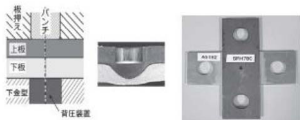
図9 スポット鍛造接合法
