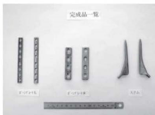
図10 インプラントの冷間鍛造（株式会社ショーテクノ）
